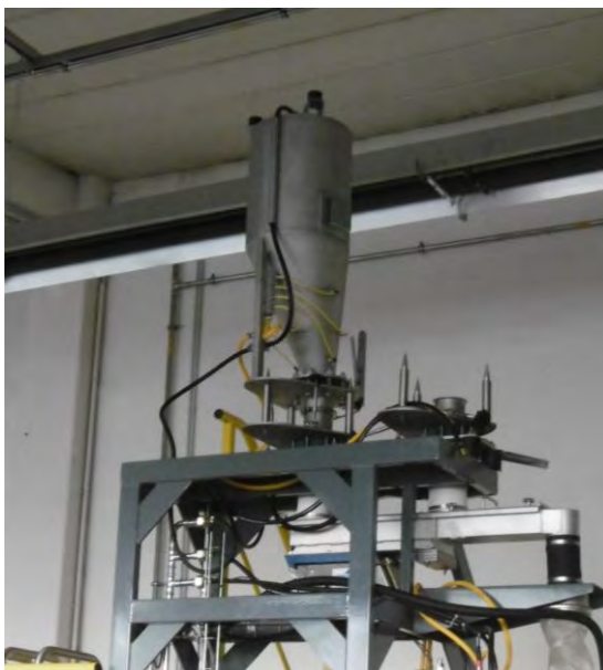
Container angedockt zur Materialzuführung
