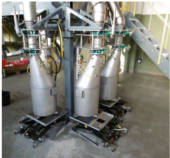
Container angedockt Materialabfüllung
