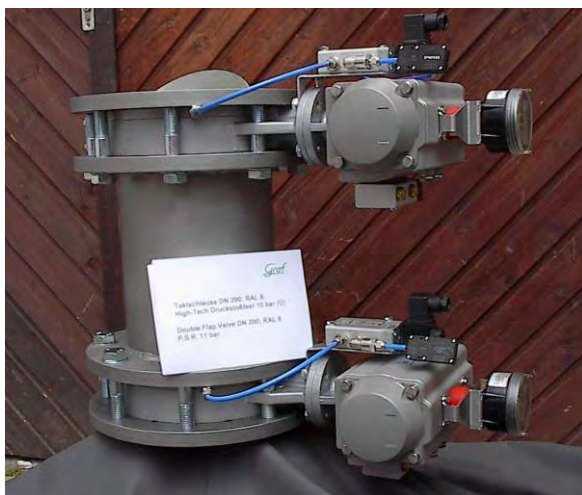
Taktschleuse DN 200 RAL 8 HighTech-Ausführung mit pneumatischer Dichtung Und verlängertem Zwischenbehälter
