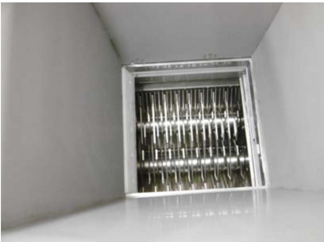
**Brecher In V4A- Edelstahl mit Zuführtrichter und Absperrschieber.
