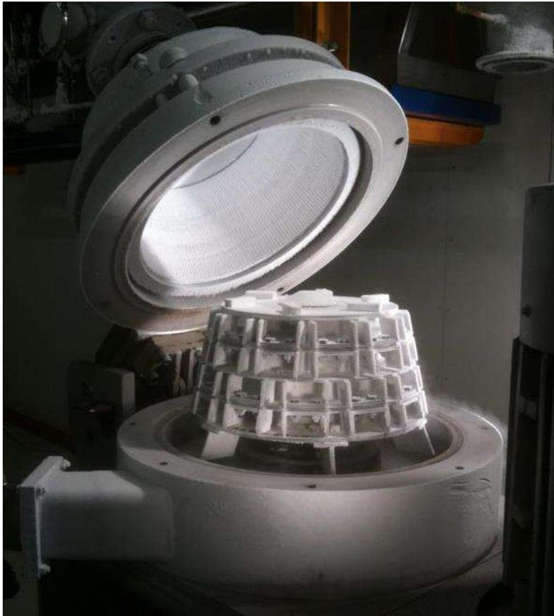
**Die Cryogenmicronisierung mit Produktkühlung in flüssigem Stickstoff ist das optimale Mahlprinzip für viele temperaturempfindliche Materialien wie:**
