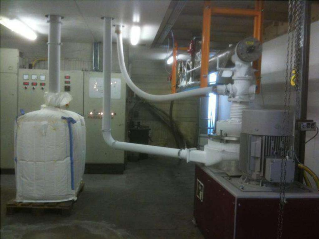
Probeaufbau einer UTM 400-Anlage in unserem Werk zum Probelauf vor der Auslieferung:
