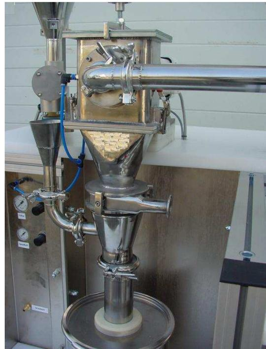
***Hochleistungswindsichter für präzise Sichtung bei hohen Feinheiten bis 97% kleiner 2  $\mu$ .***
