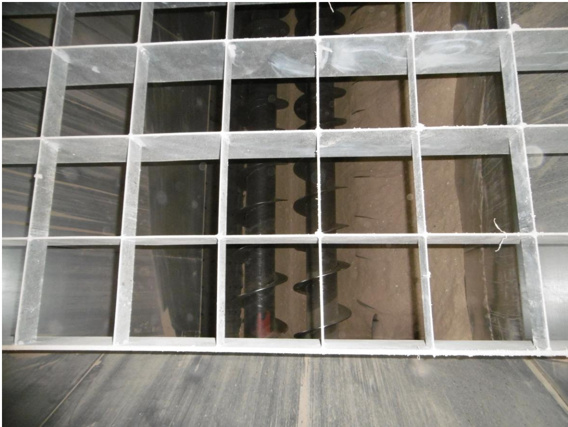
Staubschutzhäube mit doppelartigem Staubschutzvorhang
