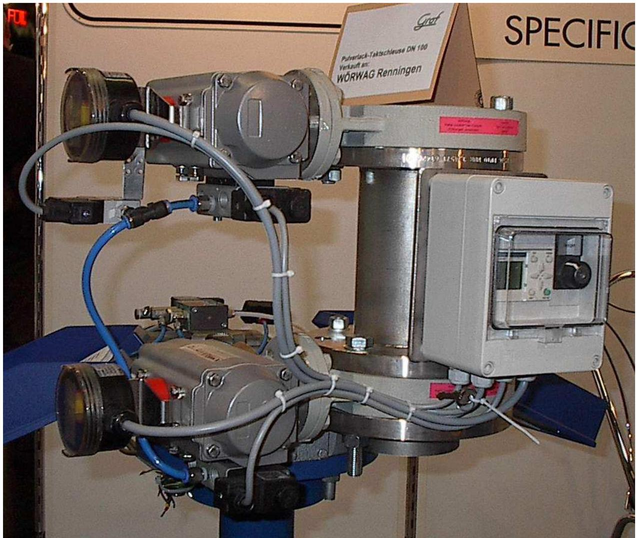
Bei Mahlanlagen mit Sichter­mü­hlen und Windsich­tern wer­den die An­la­gen teil­wei­se mit hohen Unter­drü­cken be­trie­ben. Han­delsüb­liche Zellenschleu­sen sind bei sol­chen Drü­cken als si­che­rer Luft­ab­schluss der An­la­ge oft über­for­dert.
